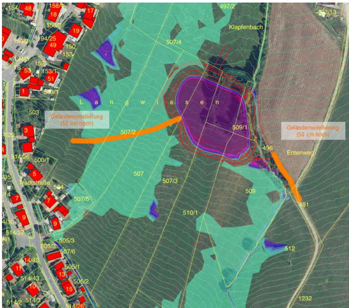
*Geländemodellierung für die Zuleitung des Hochwasserabflusses aus dem Tradtbach in das Becken*
